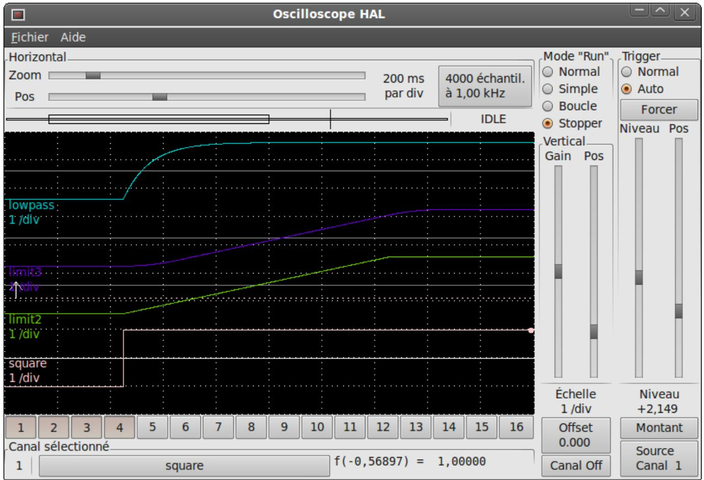
FIGURE 8.1 – Amortissement d'un signal carré
