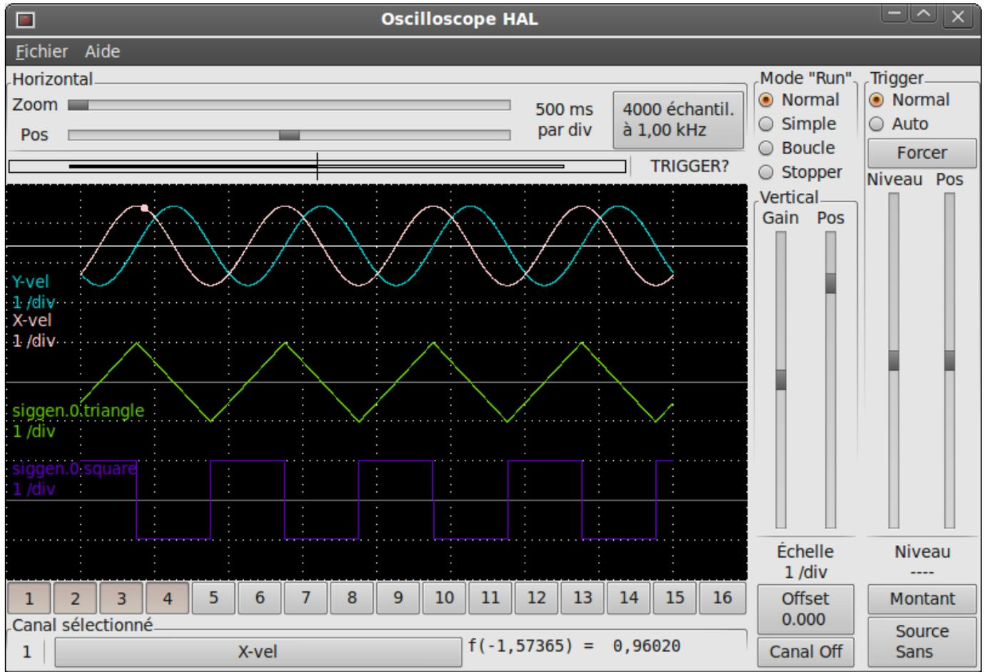
Le grand bouton *Canal sélectionné* en bas, indique que le canal 1 est actuellement le canal sélectionné et qu'il correspond au signal *X-vel*. Essayez de cliquer sur les autres canaux pour mettre leurs traces en évidence et pouvoir les déplacer avec le curseur *Pos*.
