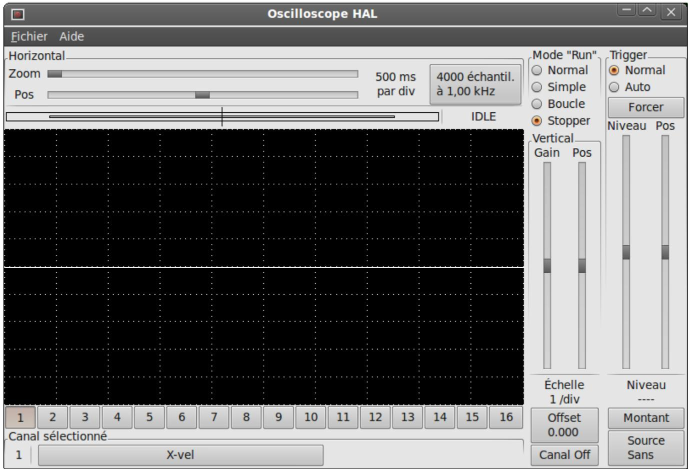
Les différents contrôles comme la position verticale et l'amplitude sont toujours relatifs au canal 1. Pour ajouter un signal sur le canal 2, cliquer sur le bouton 2. Dans la fenêtre de dialogue, cliquer sur l'onglet *Signaux*, puis cliquer sur *Y-vel*.
