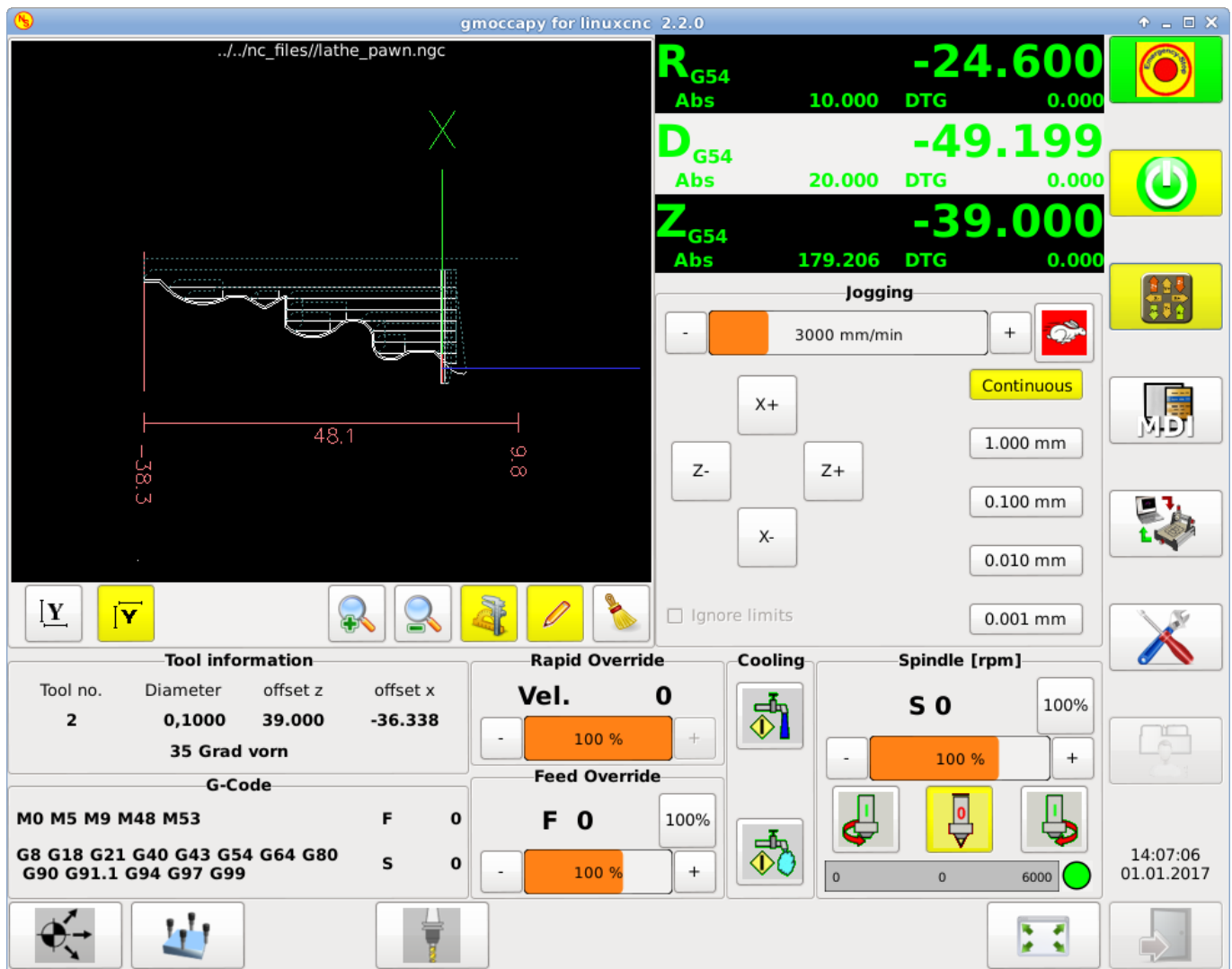
Figura 4.19: Torno con herramienta trasera
