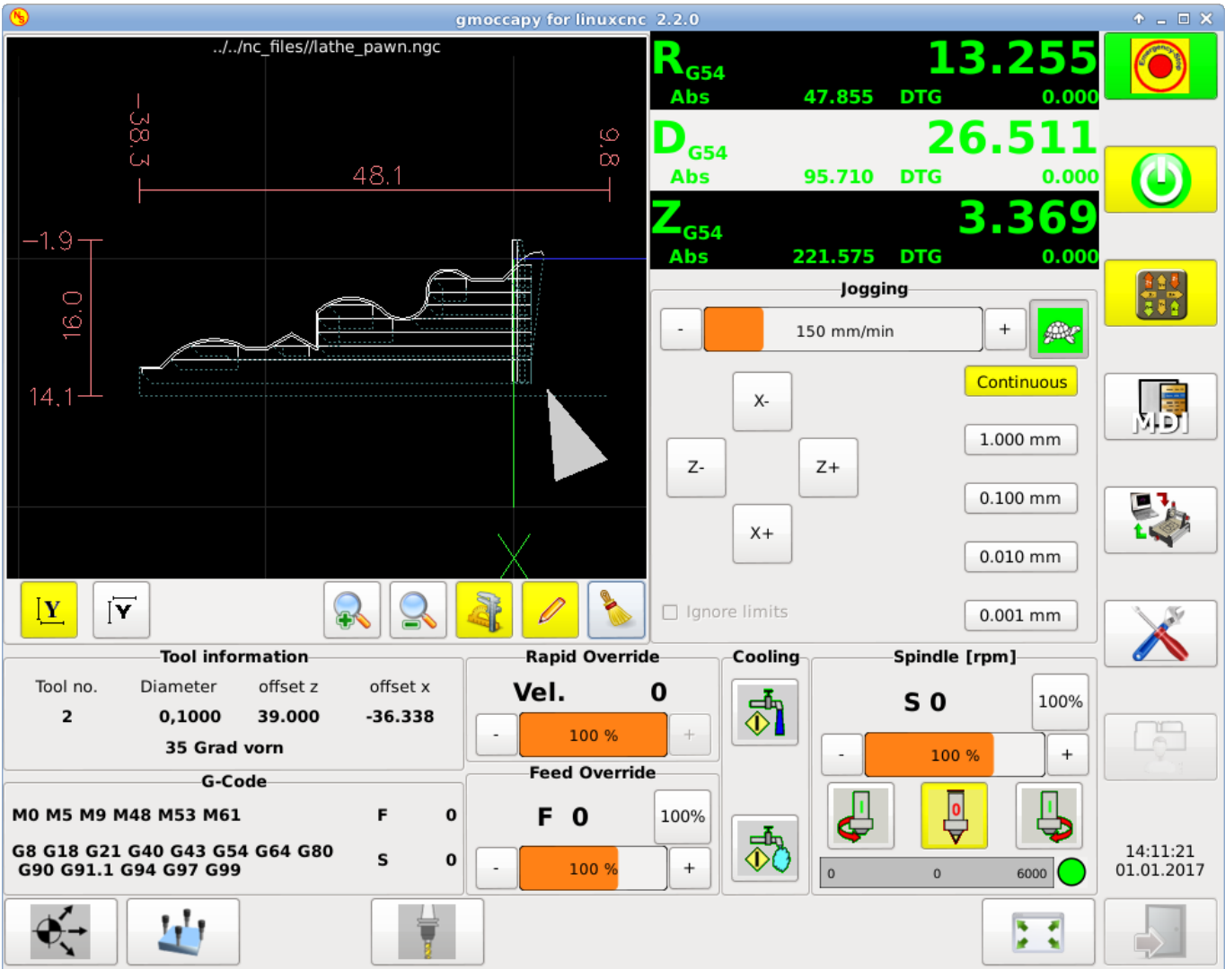
Figura 4.18: Torno normal (herramienta delantera)
