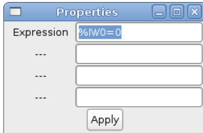
Abbildung 8.10: Beispiel für einen Vergleichsausdruck
