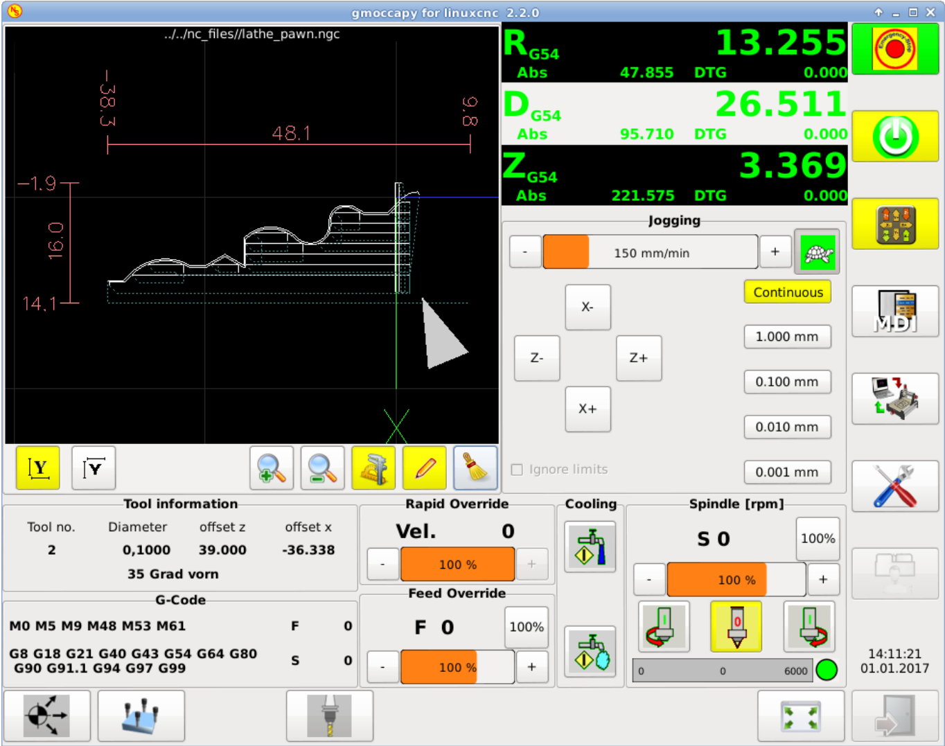
Figura 4.18: Torno normal (herramienta delantera)
