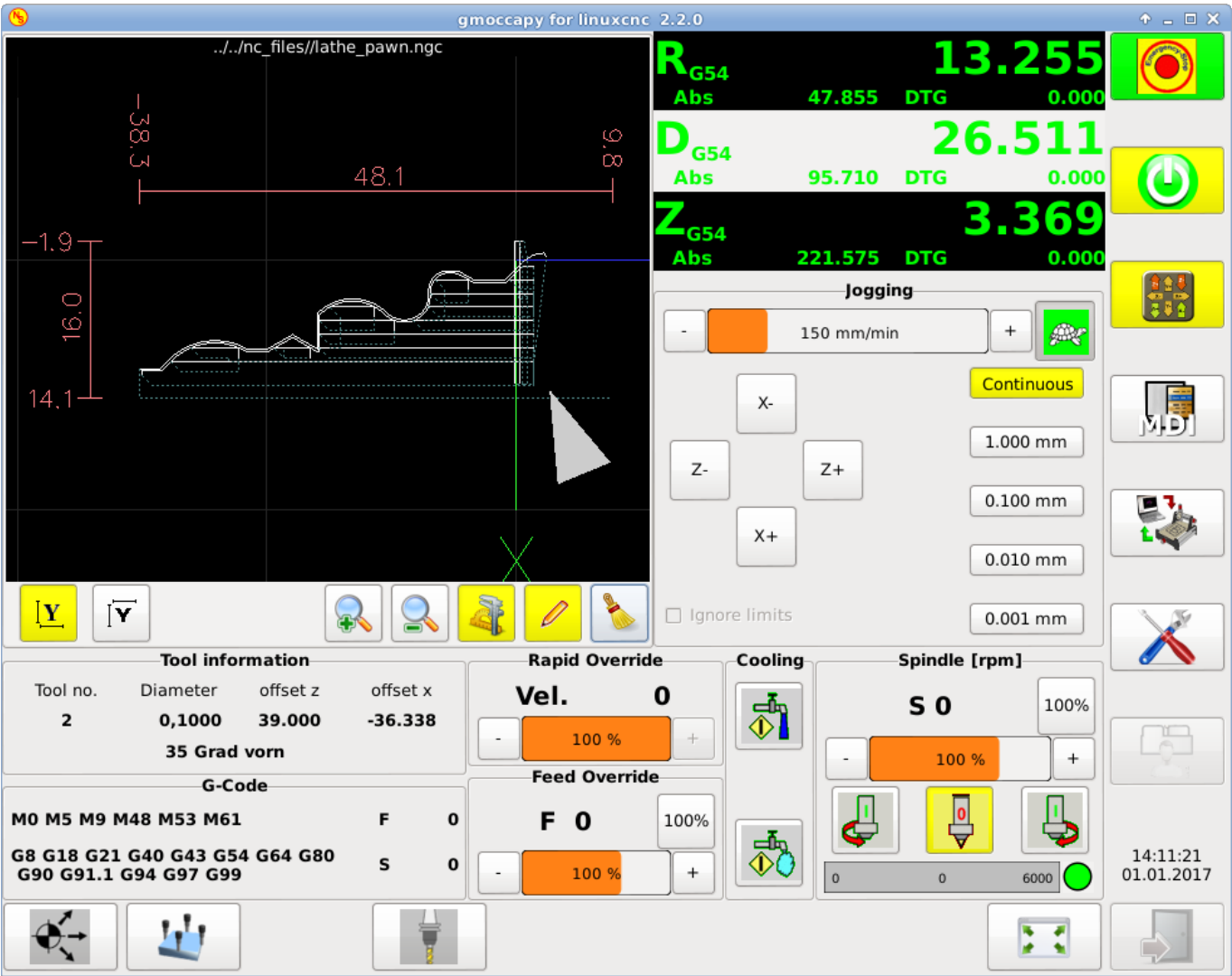
Figura 4.18: Torno normal (herramienta delantera)
