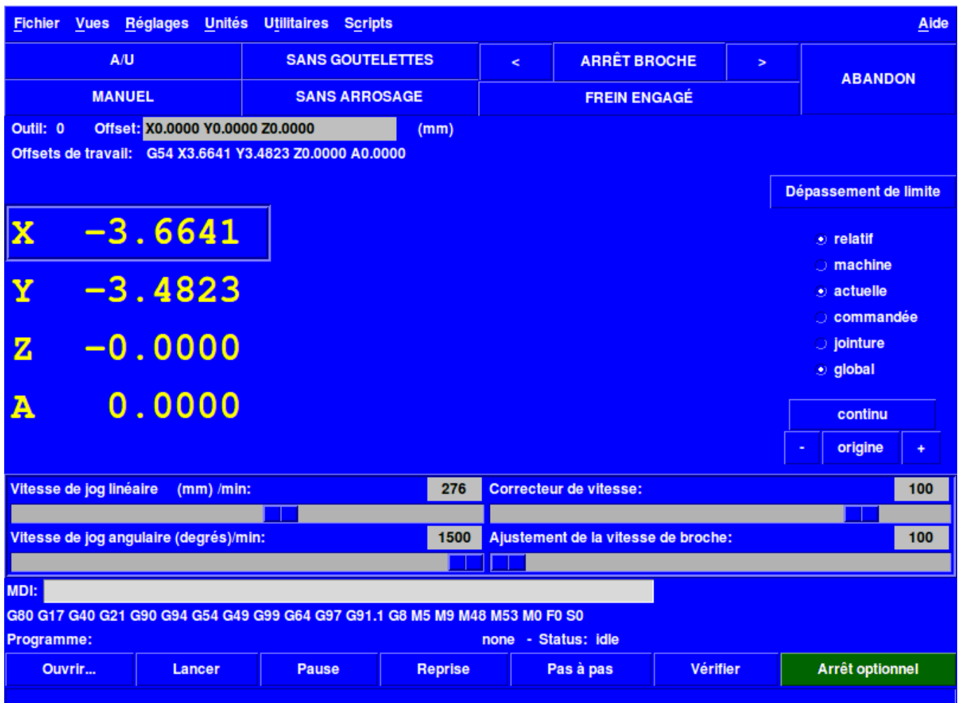
FIGURE 6.1 – L’affichage de TkLinuxCNC
