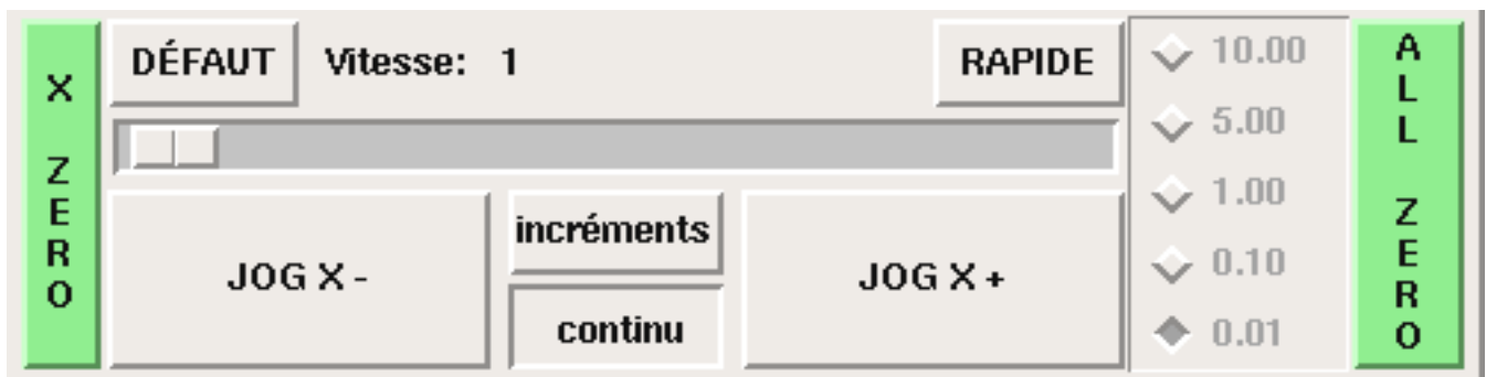
FIGURE 7.2 – Boutons du mode Manuel
