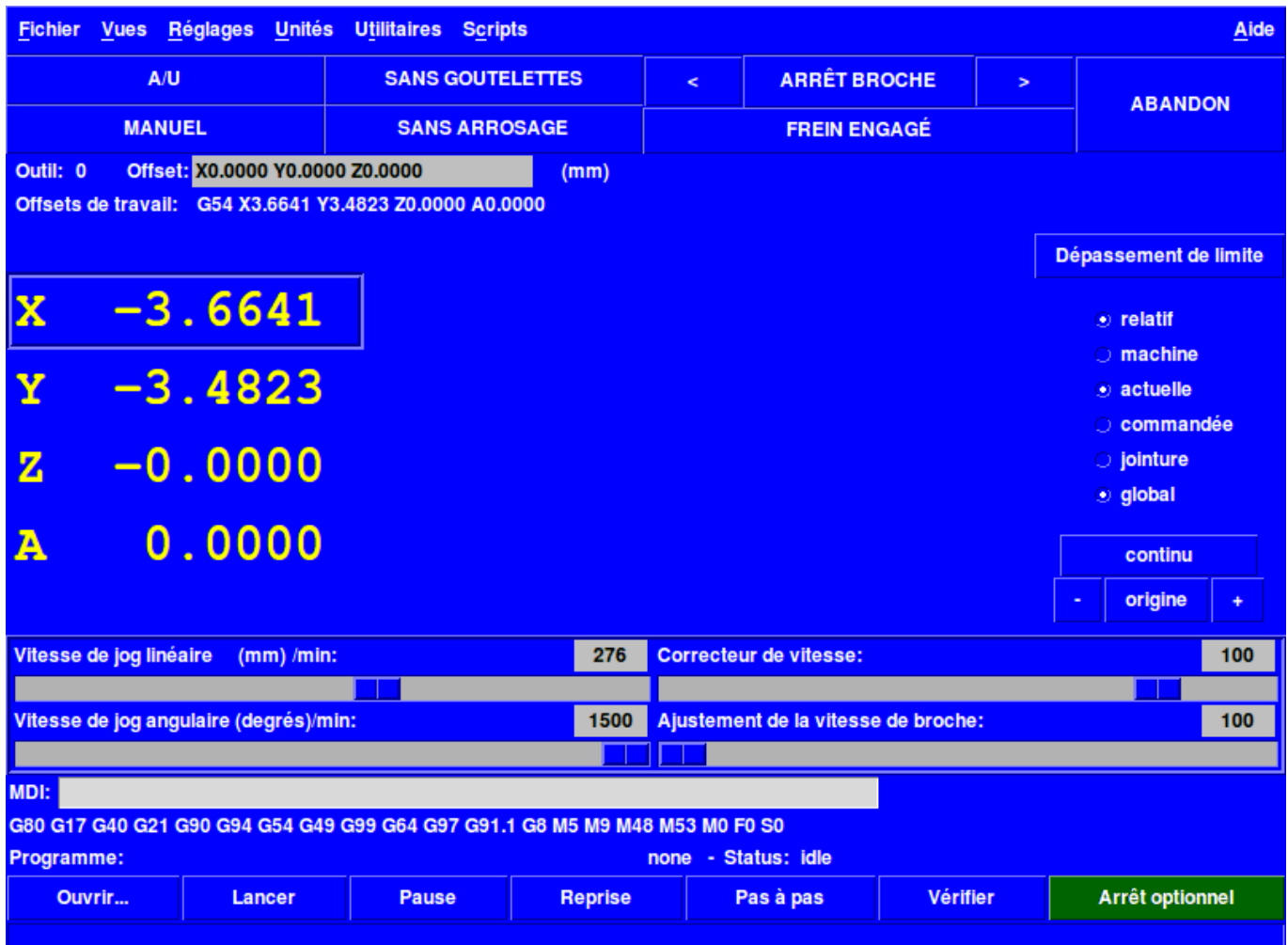
FIGURE 6.1 – L’affichage de TkLinuxCNC
