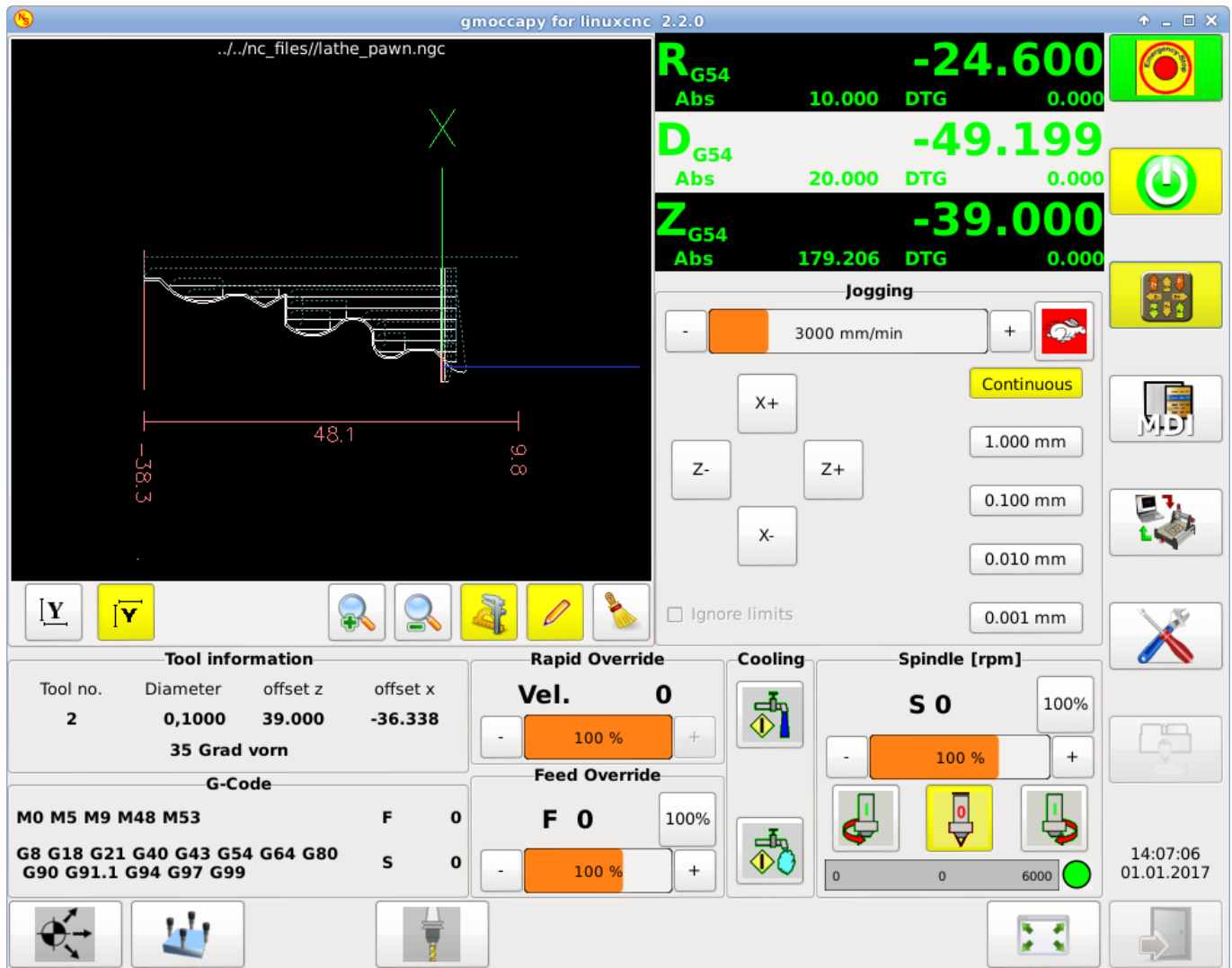
Figura 4.19: Torno con herramienta trasera
