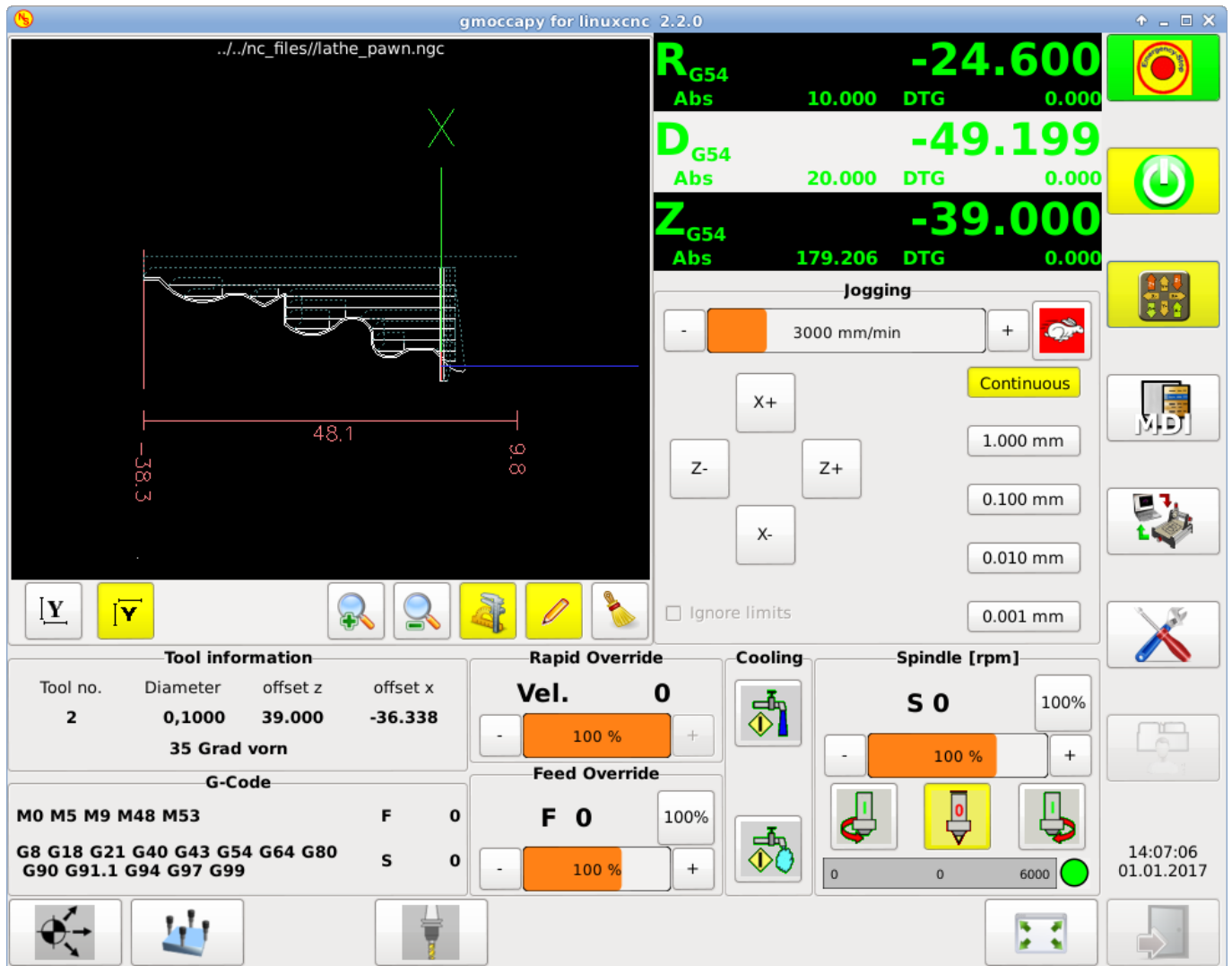
Figura 4.19: Torno con herramienta trasera
