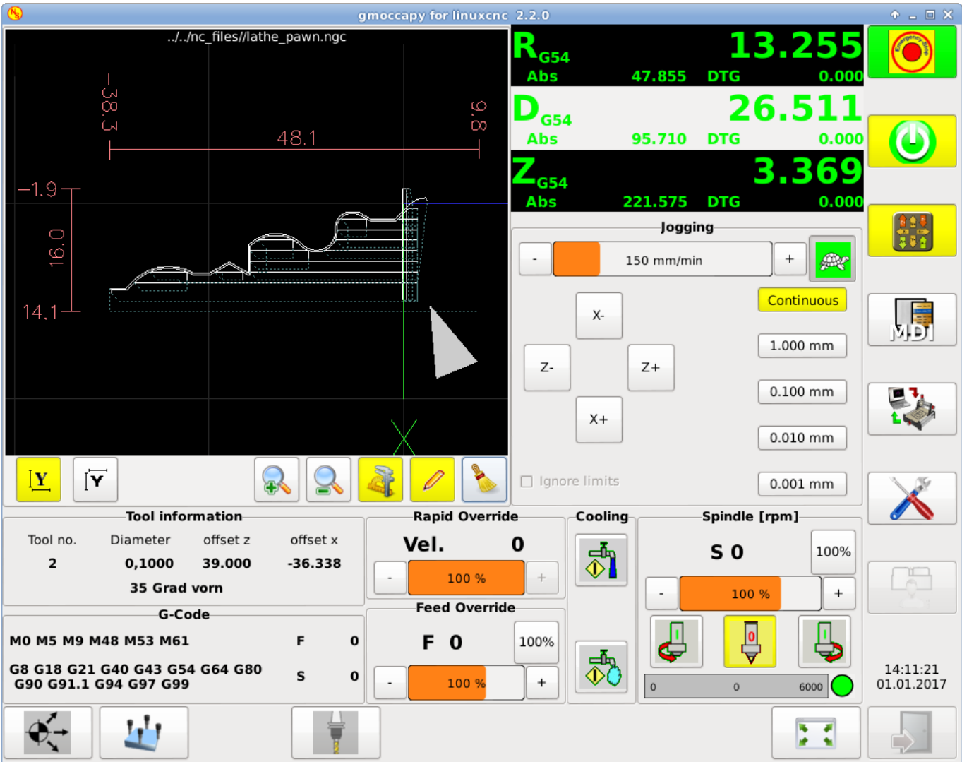
Figura 4.18: Torno normal (herramienta delantera)
