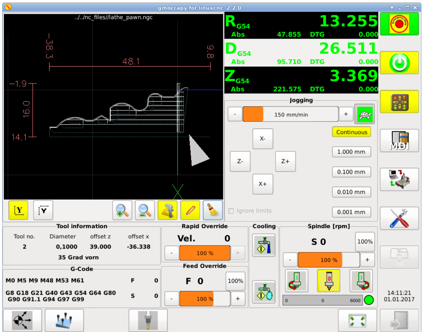
Figura 4.18: Torno normal (herramienta delantera)
