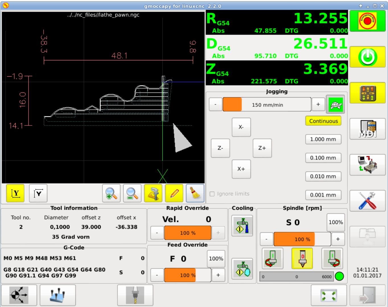
Figura 4.18: Torno normal (herramienta delantera)
