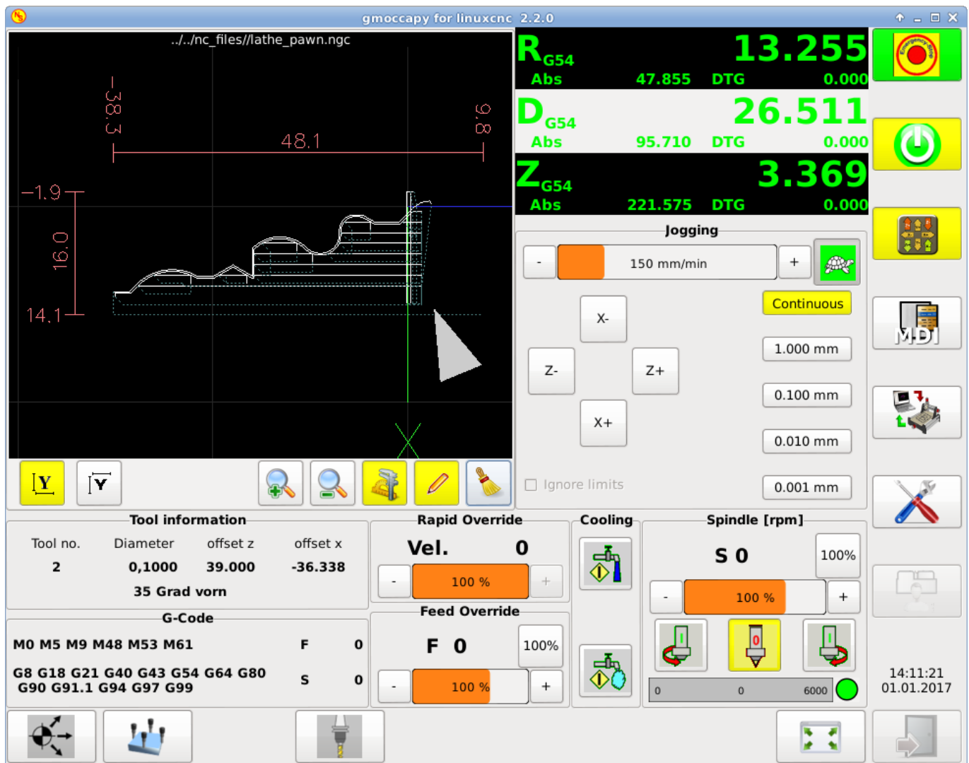
Figura 4.18: Torno normal (herramienta delantera)
