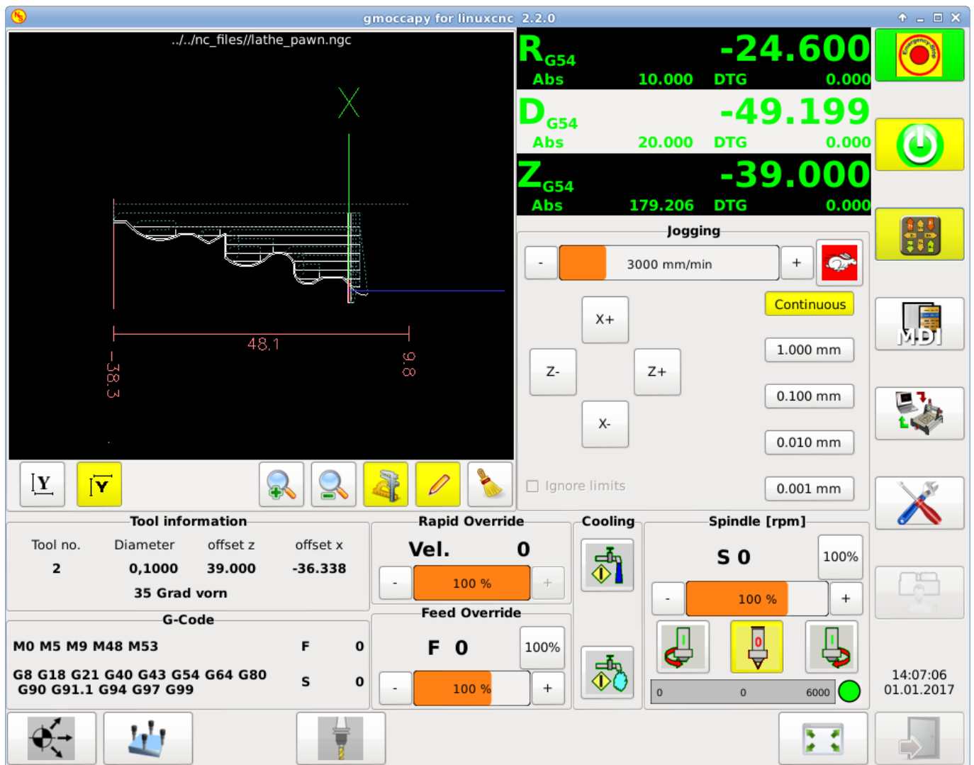
Figura 4.19: Torno con herramienta trasera
