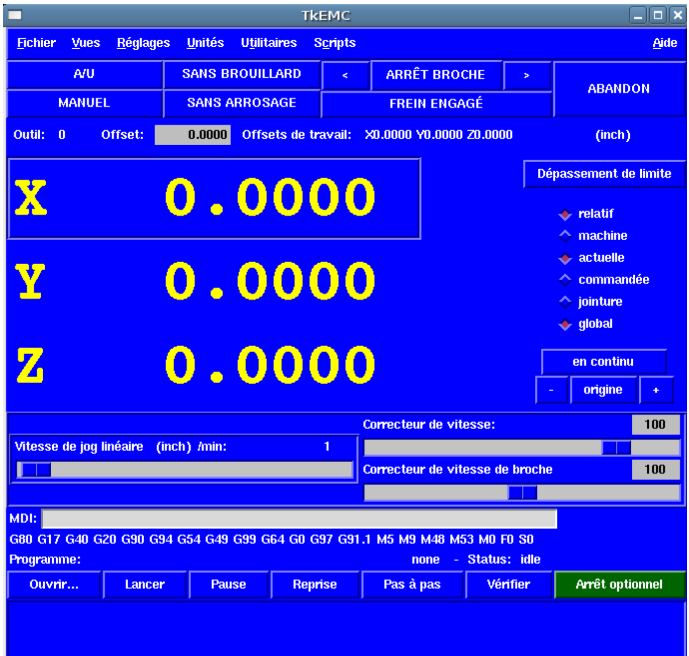
FIGURE 2.6 – L'interface graphique tklinuxcnc
