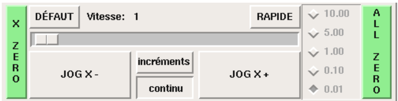
FIGURE 7.2 – Boutons du mode Manuel
