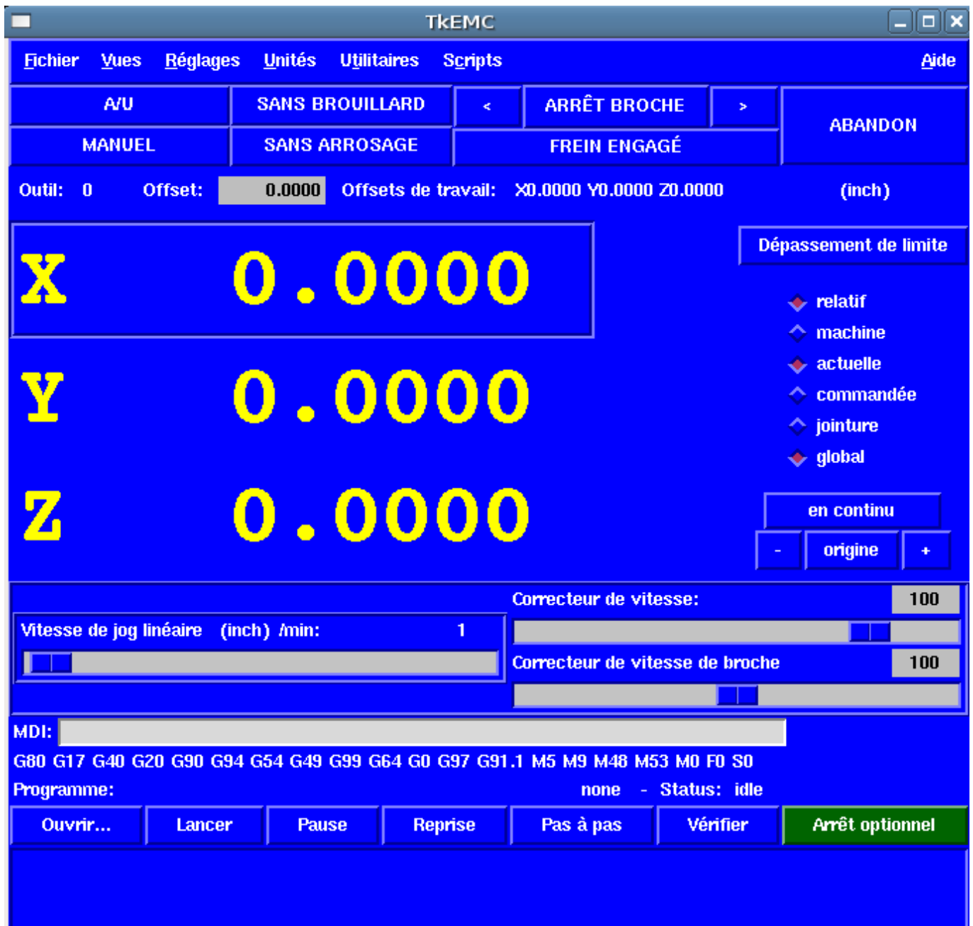
FIG. 2.6 – L'interface graphique tklinuxcnc
