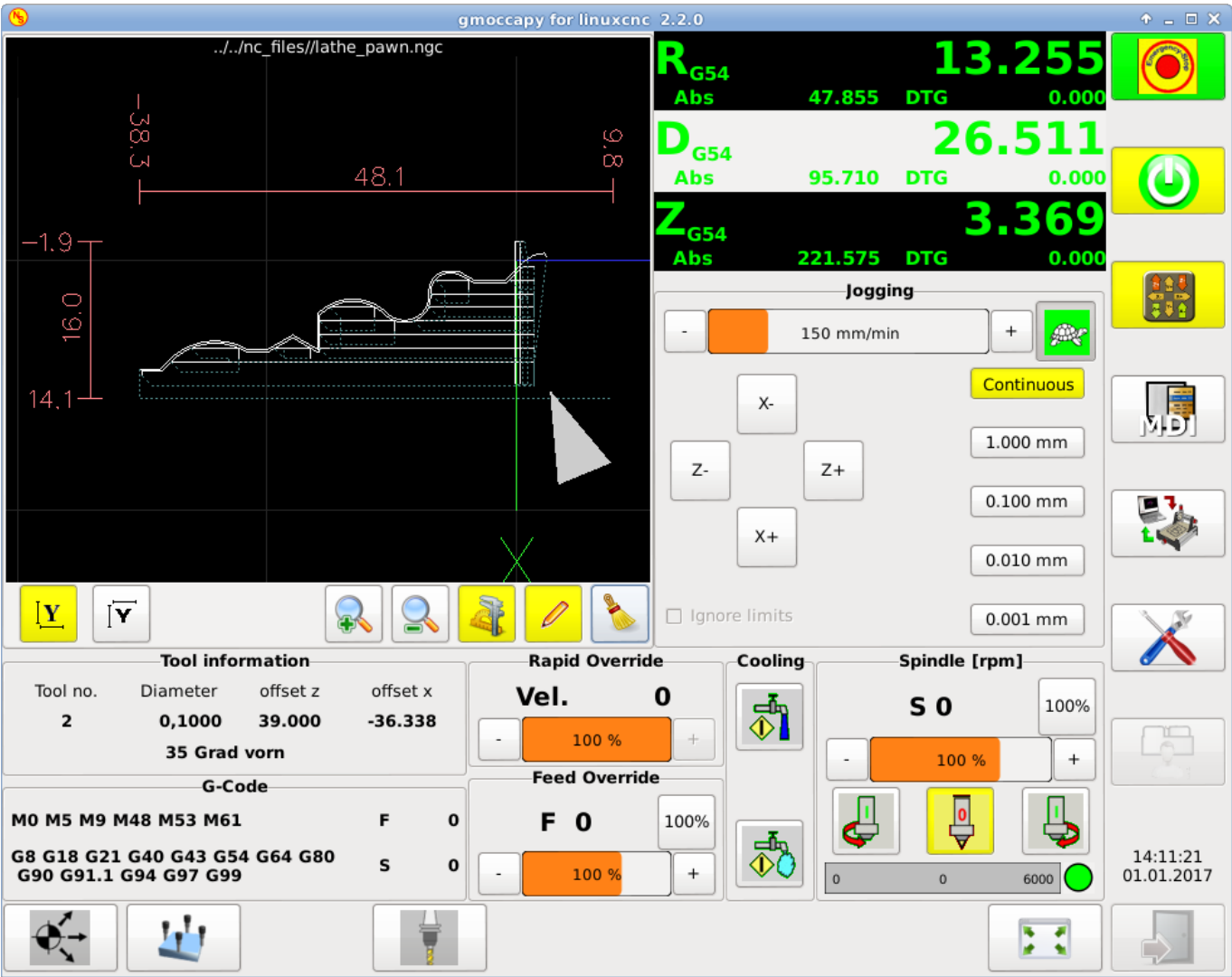
Figura 4.18: Torno normal (herramienta delantera)
