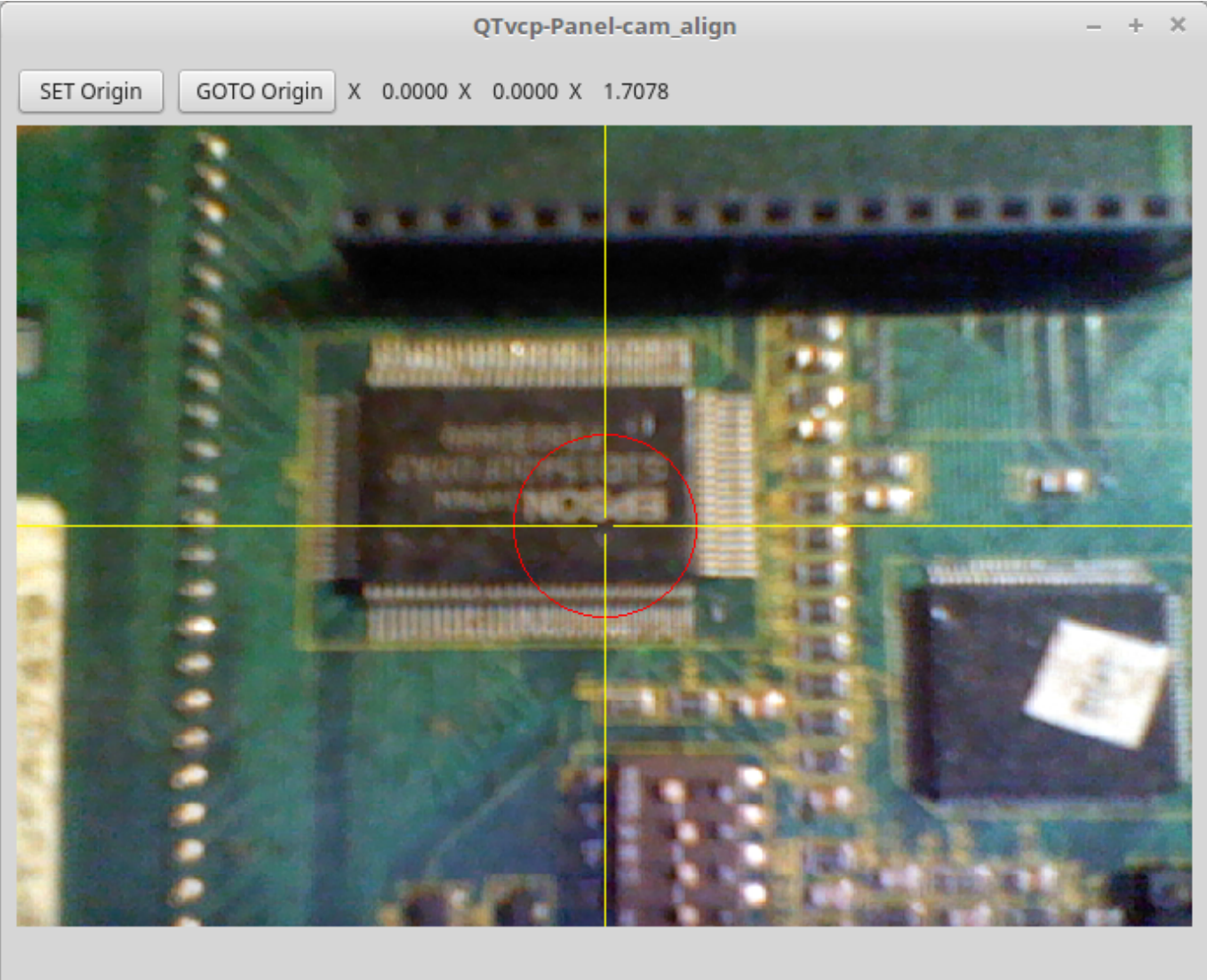
Abbildung 12.60: cam_align - Kameraausrichtung VCP
