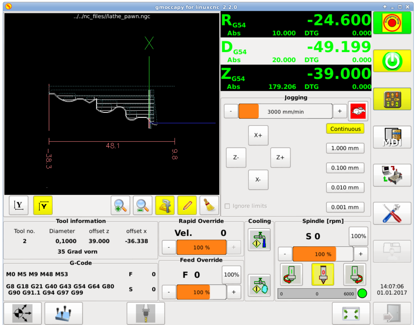
Figura 4.19: Torno con herramienta trasera
