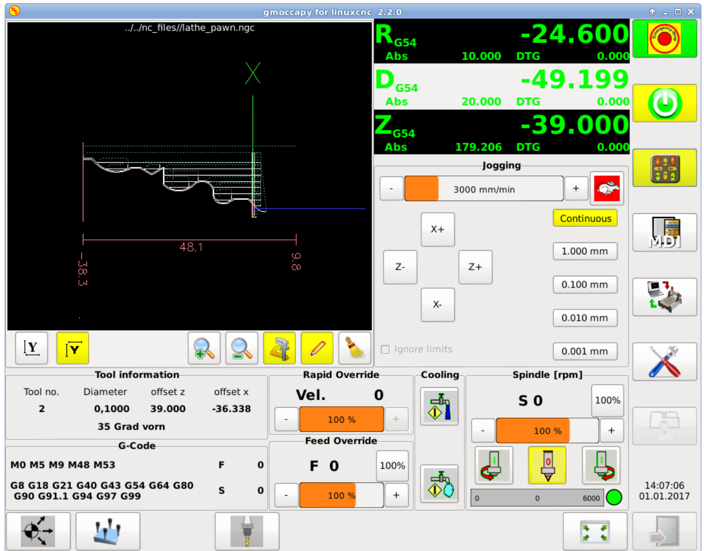
Figura 4.19: Torno con herramienta trasera
