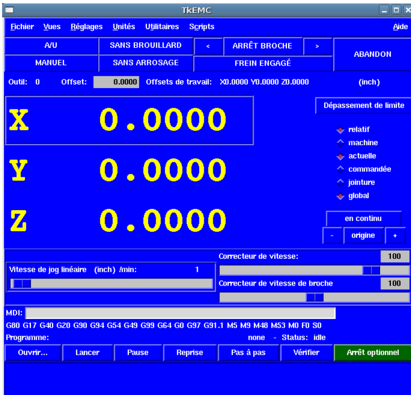
FIGURE 2.6 – L'interface graphique tklinuxcnc
